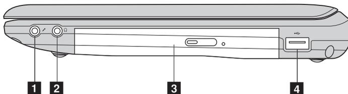
**1** 麦克风插孔      连接外接麦克风。
